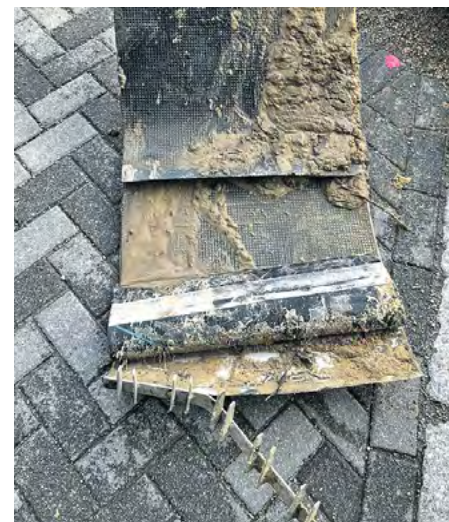
Eine Wurzel hatte die Schelle am Druckrohr scheinbar mühelos auseinandergedrückt.
